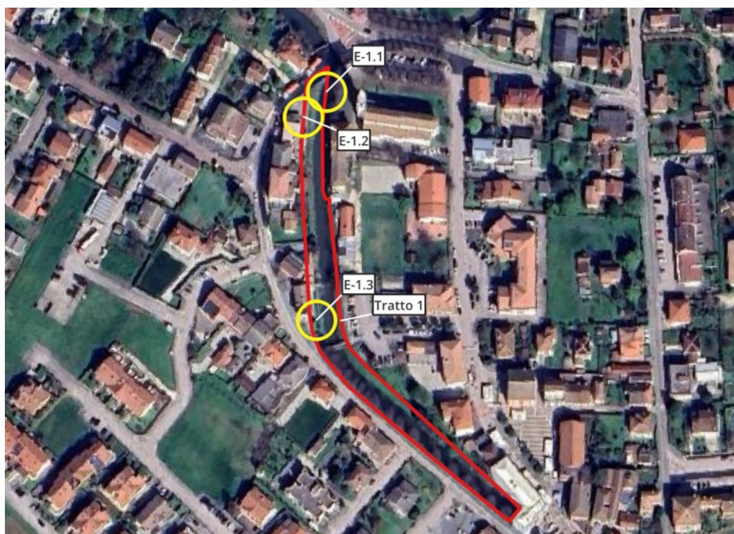
Figura 15. Ubicazione dei cedimenti spondali lungo il tratto 1.
